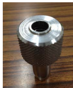
図 4 改良型ウィルソンシールの写真
