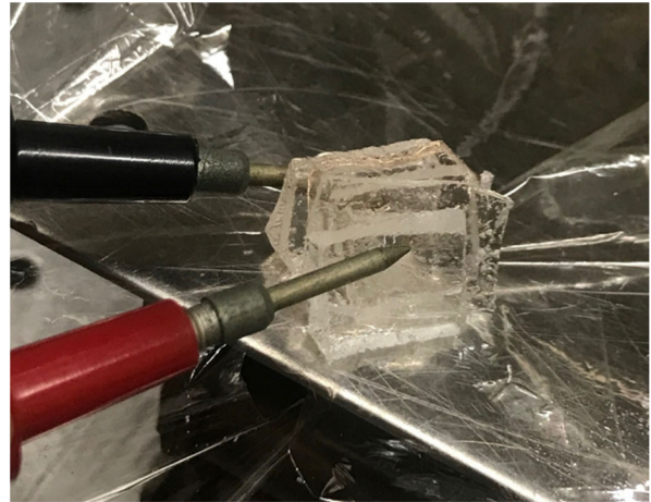
図3 テスターによるゲル電池電圧測定の様子
