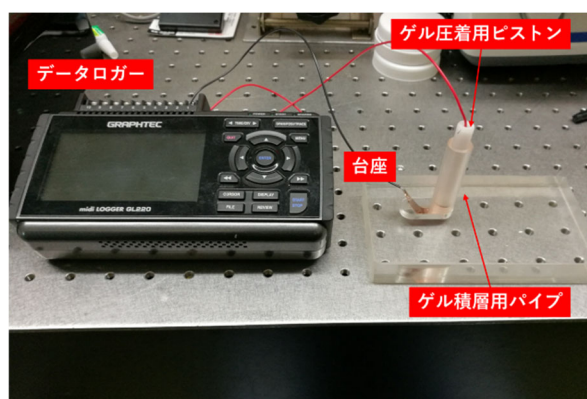
図4 ゲル電池電圧測定器具 外観
