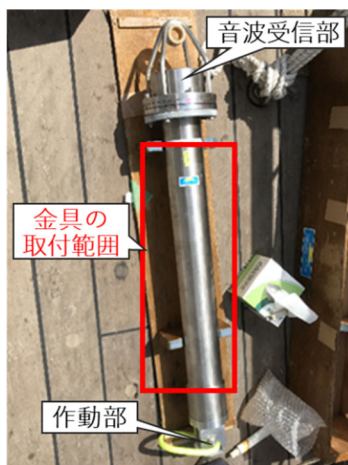
図 1 水中音響切離装置（海洋電子社製）
