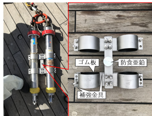
図 5 製作した切離装置連結用金具
