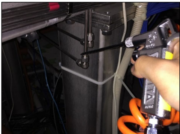
図 7 継手へのヘリウムガス噴射の様子
