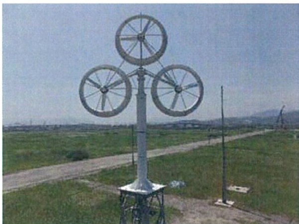
図7 北九州市響灘、3kW x 3基の 10kW マルチレンズ風車 (H28.3 月導入)
