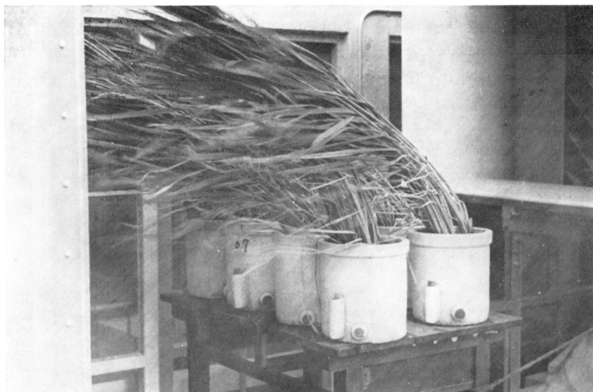
第 1 図. 風洞による強風処理の状況.
