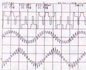
(g) 三相三重結線 (正弦波-三角波比較方式) N=5, \mu=0.8, f=48\text{Hz} V_{u1}=17.6\text{V}, I_{u1}=1.56\text{A}
