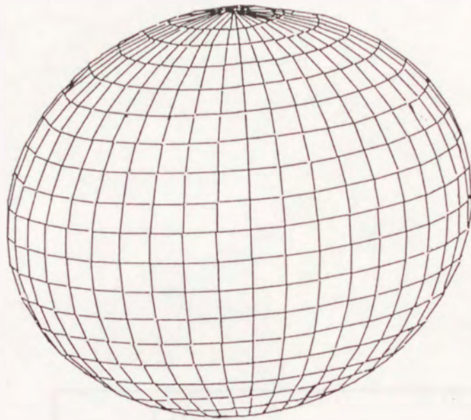
図6.26 形状および軸平面上での要素分割(球形空間)
