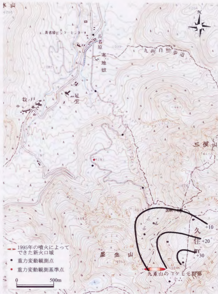
図4-7 1996年6月から1996年10月までの重力変動量の空間分布図 (単位は \mu\text{gal} )
