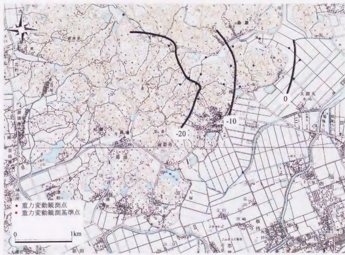
図 5-9 1996 年 9 月から 1997 年 1 月までの重力変動量の空間分布図 (単位は \mu\text{gal} )
