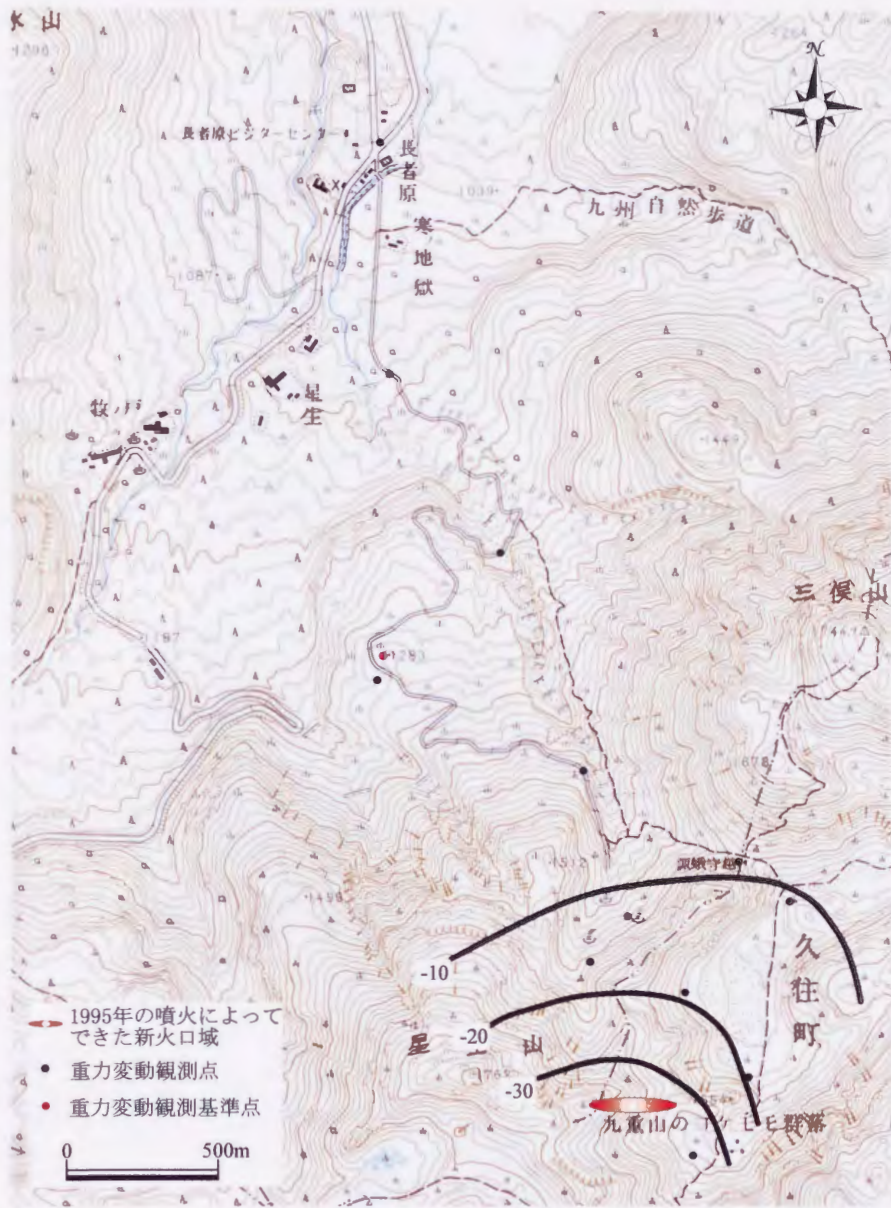
図4-6 1996年2月から1996年5月までの重力変動量の空間分布図 (単位は \mu\text{gal} )
