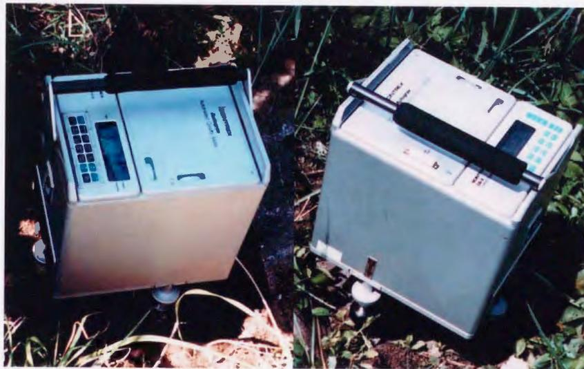
図2-3CG-3型自動重力計（左）とCG-3M型自動重力計（右）
