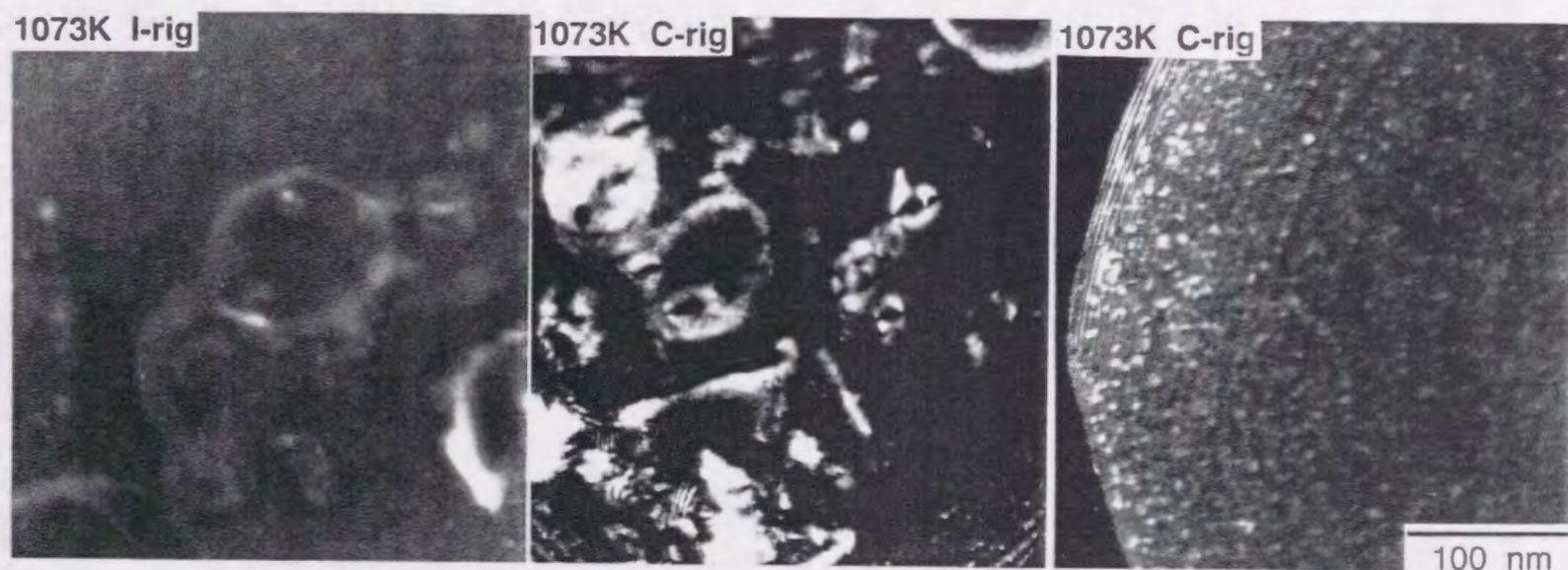
図2-20 高温用照射リグ-2を用いて1073K、 6.6 \times 10^{24} \text{ n/m}^2 にて改良型および従来型温度制御法による中性子照射を行った多結晶 \alpha\text{-Al}_2\text{O}_3 の損傷組織。入射方向は[0001]である。 写真左および写真中はそれぞれ改良型および従来型温度制御法による照射を行った多結晶 \alpha\text{-Al}_2\text{O}_3 中の転位ループ形成を示した弱ビーム暗視野像である。それぞれの結晶粒は 5\sim 7\mu\text{m} である。損傷組織に大きな差はみられない。 写真右は従来型温度制御法による照射を行った多結晶 \alpha\text{-Al}_2\text{O}_3 中のボイド形成を示した弱ビーム暗視野像である。結晶粒は写真左、中のものより小さく約 2\mu\text{m} である。転位ループ形成はみられずボイドのみが観察される。
