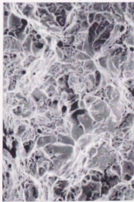
図 6-22 単独穴切欠き材の破面 (S45C材, \rho = 0.1 \text{ mm} )
