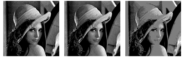
図 2: 誤差拡散法によるハーフトーン化
