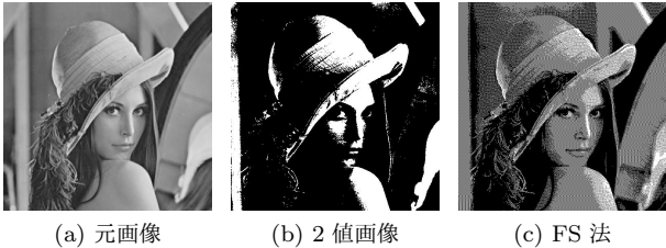
図 1: グレースケール画像の 2 値化とハーフトーン化 方、ISNR 値は図 (b) が 9.40dB、図 (c) が 18.86dB となり、PSNR 値よりも大きな差が出た。
