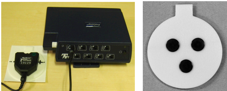
図 2 , 3 携帯型筋電図測定装置 (左)、ディスプレイアブル Ag / AgCl 電極 (右)
