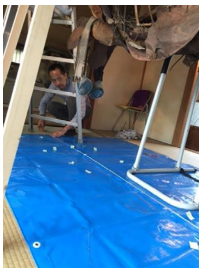
写真 2-2-3 「基準線」を床面に投影した線にメジャーを固定 42
