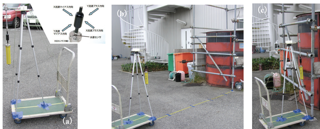
Fig. 1 流向流速計を固定した実験用台車 (a)、台車と鋼管との距離が最遠時 (300cm) の状態 (b)、台車と鋼管との距離が最近時 (10cm) の状態 (c)
