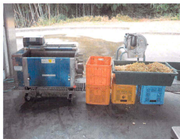
図 18 細切作業での洗浄機・細切機の組み合わせ
