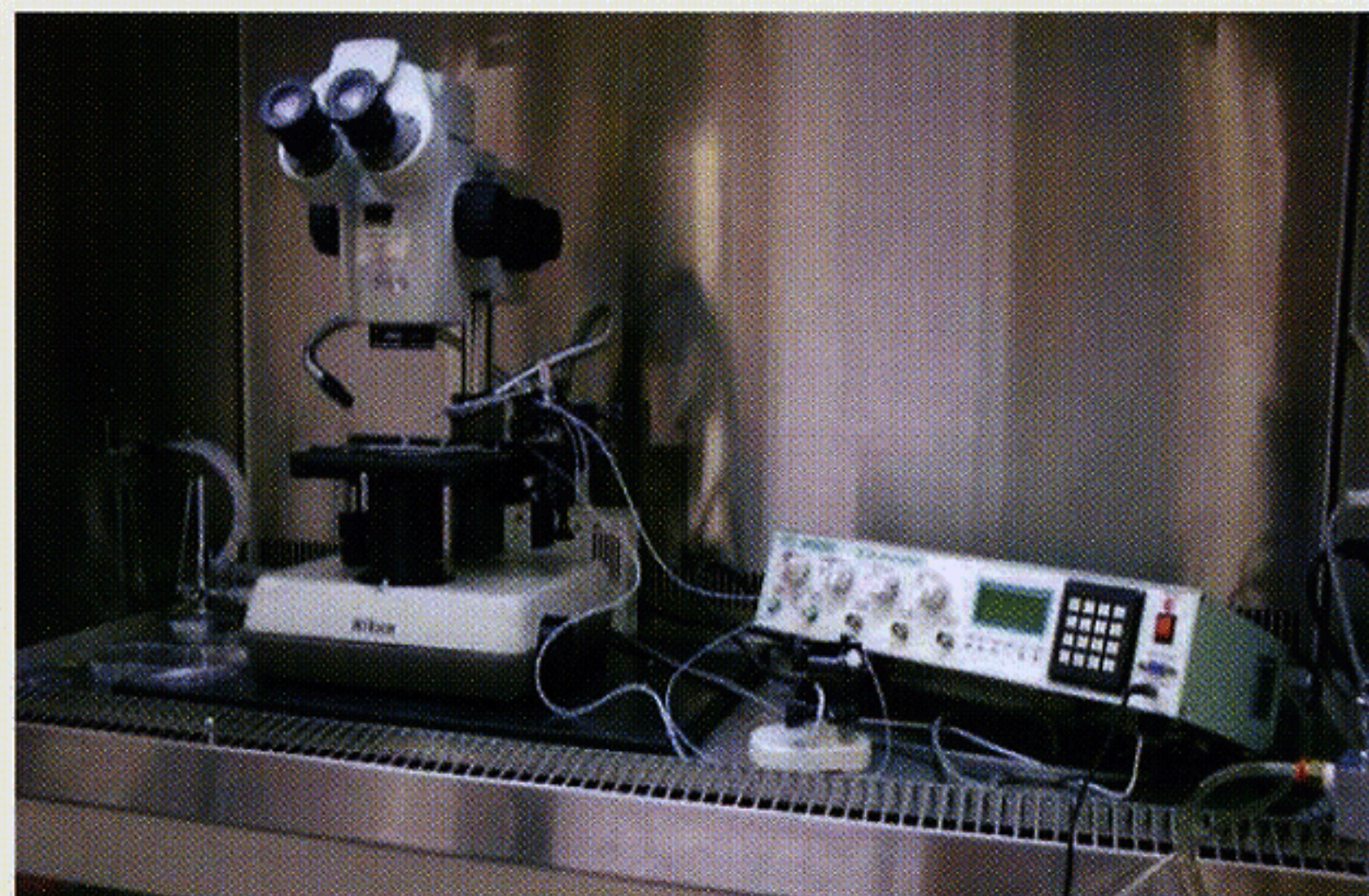
図1. カイコ卵へのDNAの微量注射装置
