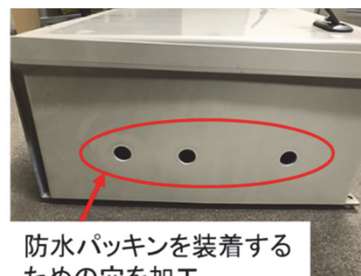
図 12 加工した防水パッキン用の穴
