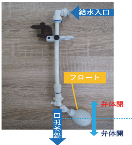
図3 フロートバルブの全体図
