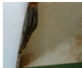
図8 表紙の芯材が破損した本
