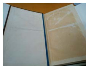
図6・7 左図の変色した遊び紙の裏(右図)には変色がなく、表紙芯材の影響による変色だと想定されることも興味深い
