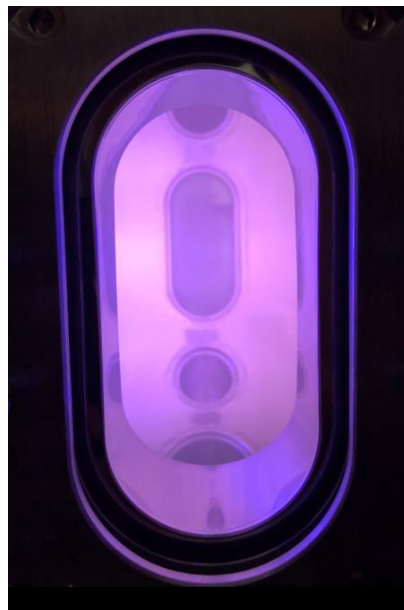
図 4.10 HYPER-II 装置の楕円窓 (長軸 66.5 \text{ mm} )。
