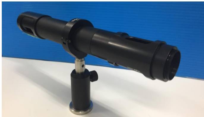
図 3.13 レーザ一周波数メモリ較正に用いた FPI の写真。 (上) \text{FSR} = 296 \text{ MHz} 、(下) \text{FSR} = 373 \text{ MHz} 。
