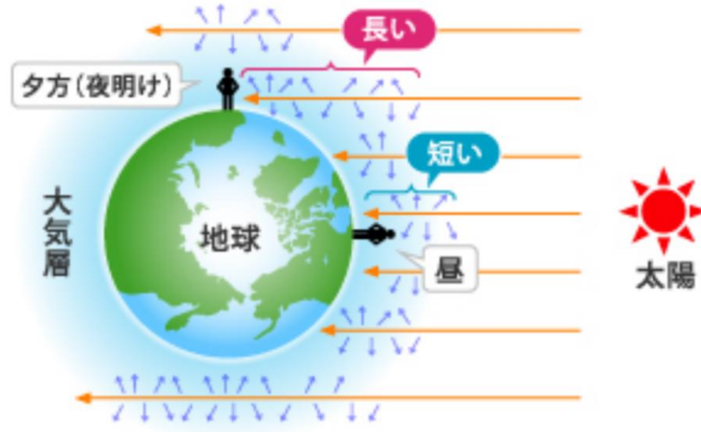
図 3.2 レーリー散乱による太陽光の散乱 [11]
