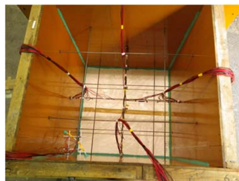
写真 4.1 含水率センサの設置状況
