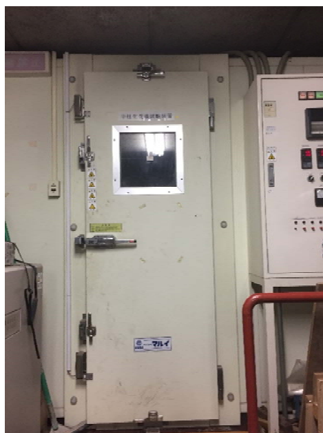
写真 5.3 中性化促進試験装置
