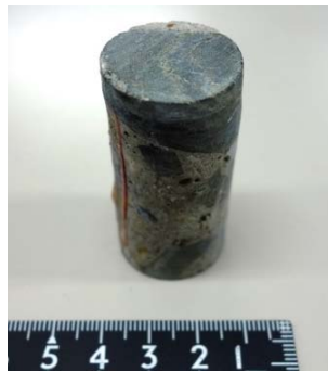
写真-3.3 φ25mm コア外観 (粗骨材最大寸法 40mm)
