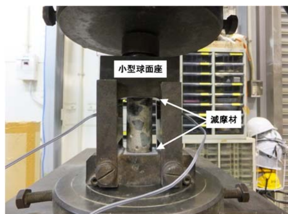
写真-3.2 載荷試験方法 ( \phi 25\text{mm} )
