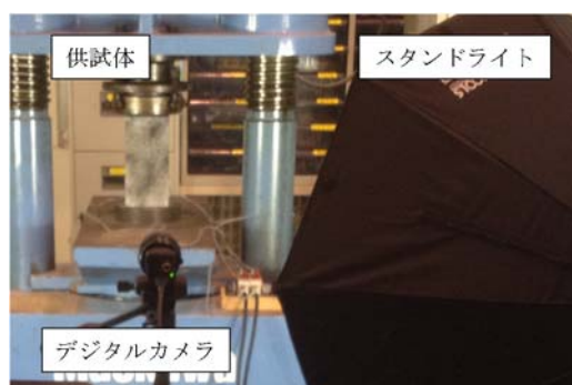
写真-5.2 圧縮載荷試験の状況
