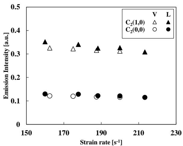
図 3-5 L 変化と V 変化の比較 (C<sub>2</sub> スワンバンドの発光強度)
