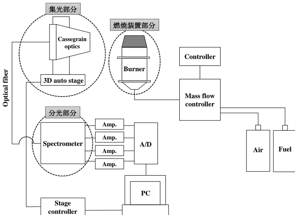
図 2-1 発光分光システム概略図
