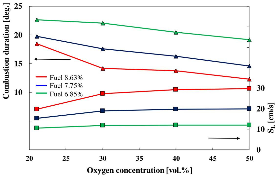
図 5-13 燃焼期間と層流燃焼速度
