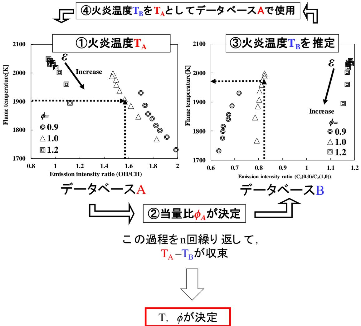
図 3-19 乱流予混合火炎の温度の推定手法
