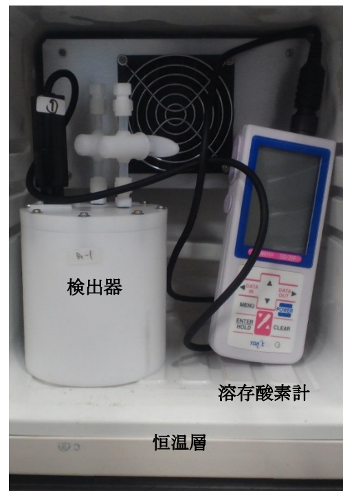
図 2-4 溶存酸素測定検出器の模式図。 図 2-5 溶存酸素測定実験の検出器写真。
