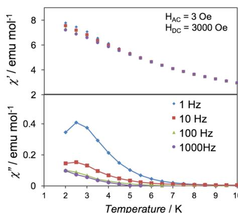
**Fig. 3** **Ni<sub>7</sub>L5\_N<sub>3</sub>** の交流磁化率の周波数依存性
