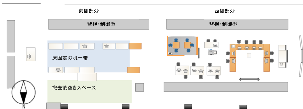
図3 制御室東側旧制御機器等撤去後の空きスペース
