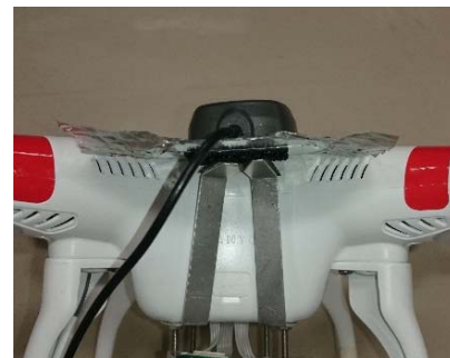
図 8 直達波計測アンテナ 搭載部分
