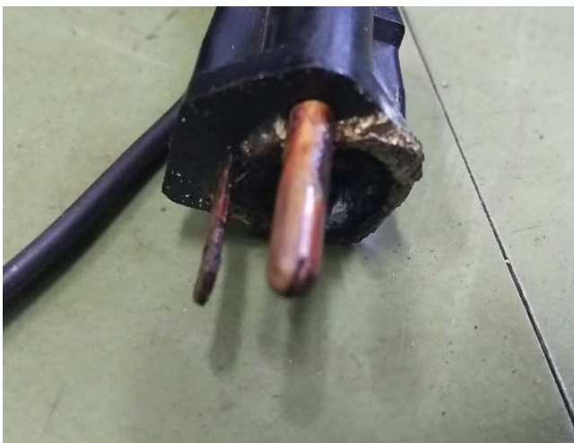
図1 溶断したプラグ
