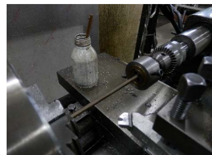
図 12 旋盤を利用した切削
