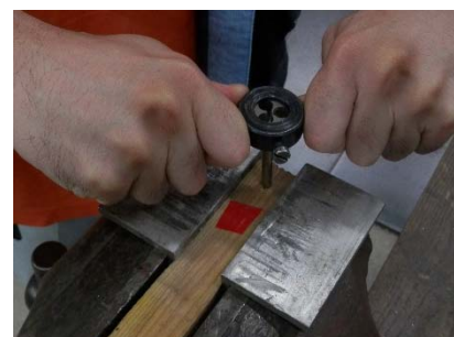
図 9 ダイスハンドルを利用した切削
