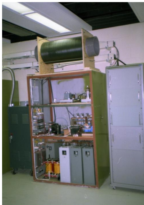
図 16. オーミック放電用電源回路
