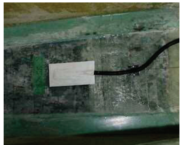
図3 ブレード歪センサ取付け状況(防水処理後)
