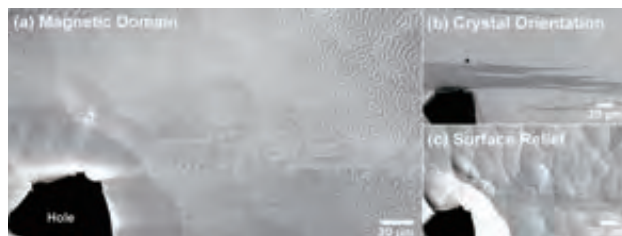
図2. 異なる電子検出器で取得したCo-Pt強磁性合金の (a) 迷路状磁区構造を示すSEM像 (b) 結晶方位の違いを示すSEM像 (c) 表面形状を示すSEM像
