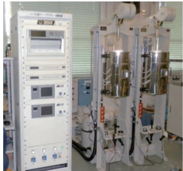
図1 テコ式クリープ試験機の外観
