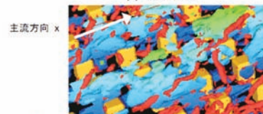
(c) 白破線枠の拡大図 (低速流体塊(青)と渦構造(赤)の関連)
