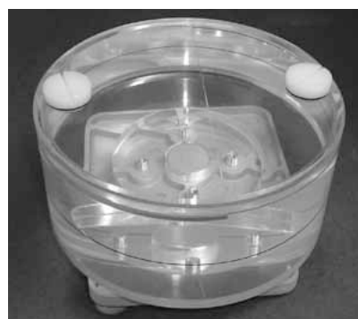
図4 自作ワイヤファントム(左)と水ファントム(右)
