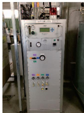
図2 ヘリウムガス分析システム外観
