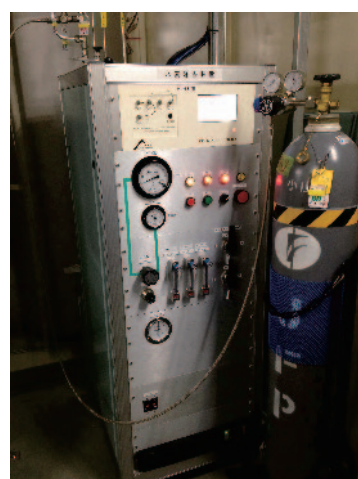
図3 水素除去装置外観
