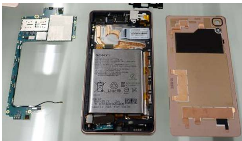
(b) スマートフォン(Xperia X Performance)の分解画像(ASCII より引用)
