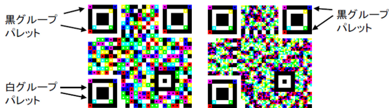
図 3-20 高密度方式のパレット色の設定
