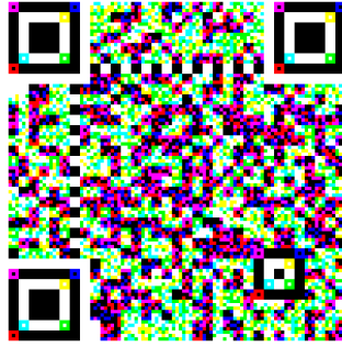
図 5-4 多値セル型二次元コードの例
