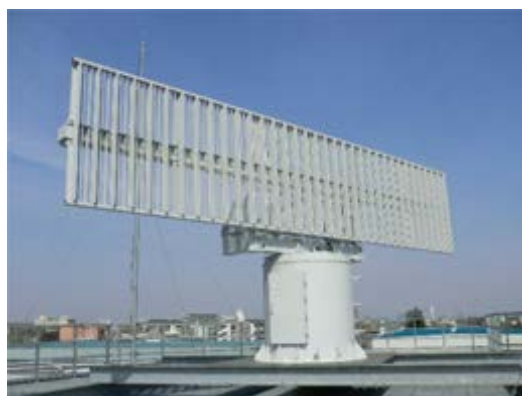
図 6-3 電子航法研究所 SSR モード S アンテナ
