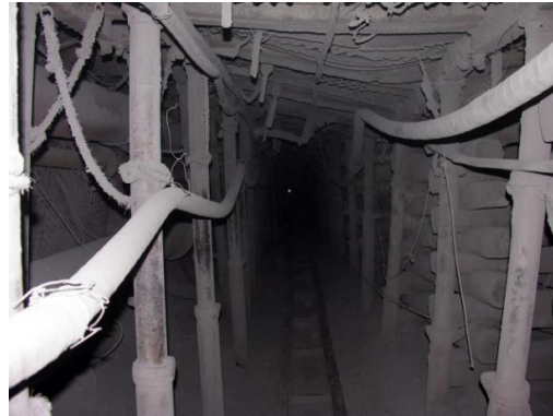
(d) Single hydraulic props
