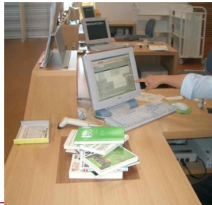
図書に貼付されたバーコードとRFIDタグ RFIDリーダーで複数の図書を読み取り
