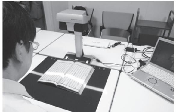
オーバヘッド非接触式スキャナSV600を用いた漢籍の電子化
