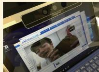
Kinect は全身の動きを認識するのに非常に優れていますが、カメラとの距離が近い場合は認識が難しくなります。逆に、RealSense は、全身を撮るようなカメラから遠い距離での認識は難しいのですが、近い距離の場合は非常に認識に優れています。動作の認識以外にも、Face Tracking や Eye Tracking など、細かい部分に関しても認識が可能です。
