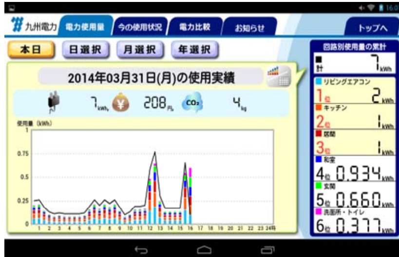
図2.4 電力使用量実績 (kWh/30min) 画面
