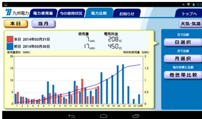
図2.5 電力比較画面 (日別電力使用量推移の例)
