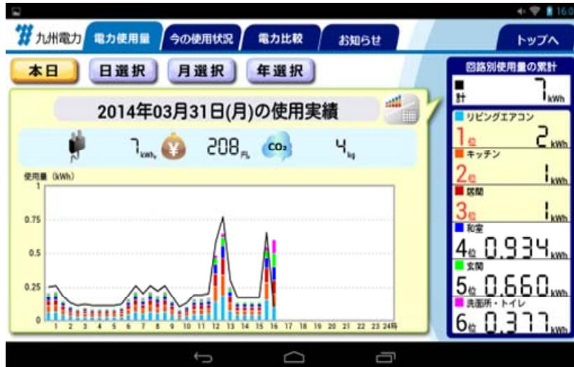
図2.4 電力使用量実績 (kWh/30min) 画面
