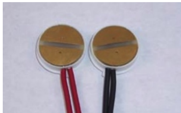
図 3.1: (上) 電気喉頭計装置 (Glottalenterprises 社製 EG-2) (下) EGG 電極 (Glottalenterprises 社製)
