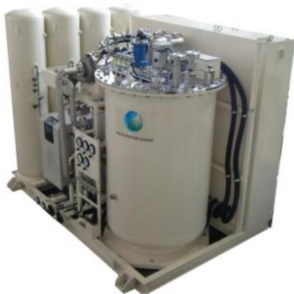
図 7.1 2kW ネオターボブレイトン冷凍機実用機
