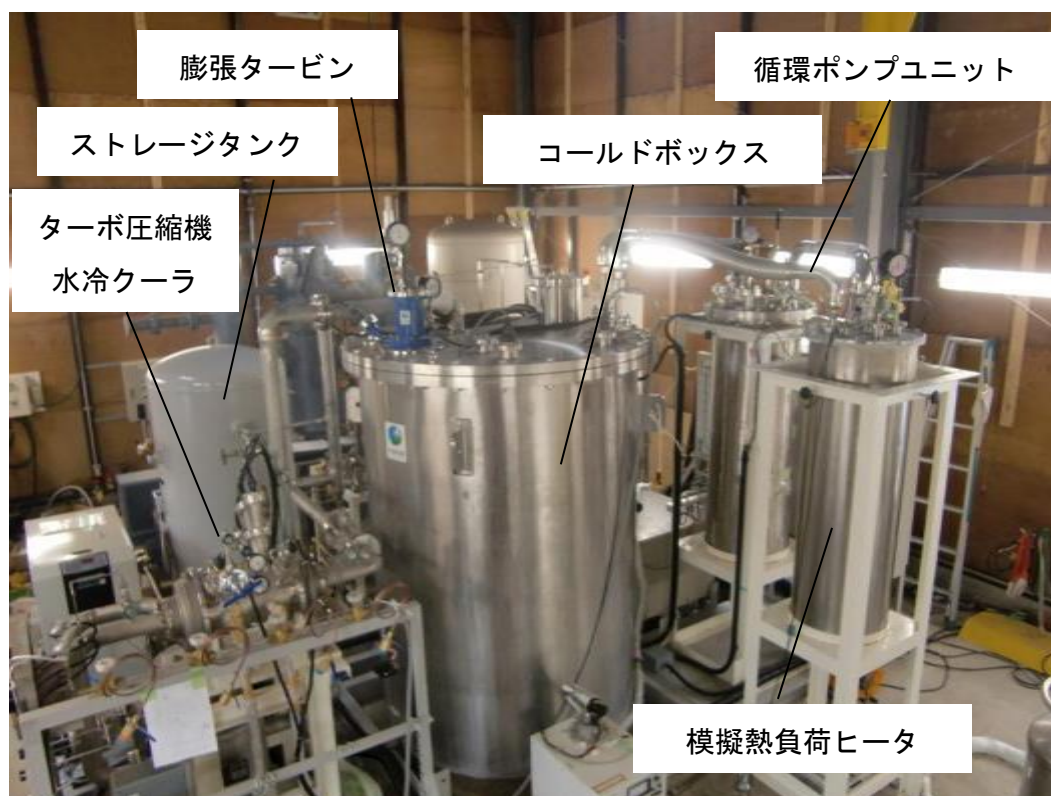
図 6.4-1 実証用ネオン冷凍機写真
