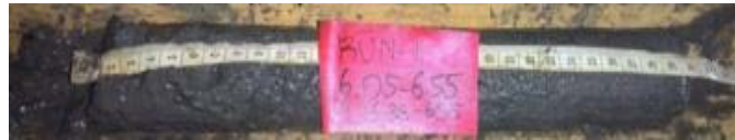
BG41_6.05 – 6.55m (セメント攪拌注入前)
