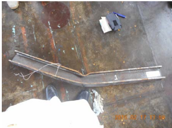
(d) 試験終了後の供試部材(No.1)
