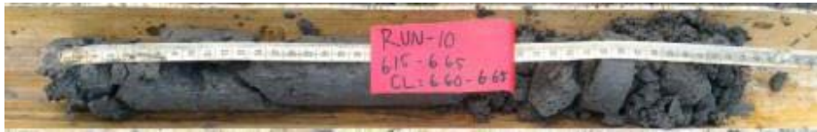
BG41_6.15 – 6.65m (セメント攪拌注入後)
