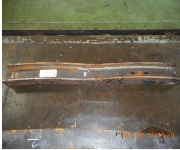
(f) 試験終了後の供試部材(No.6)
