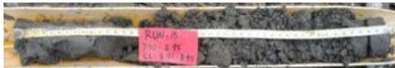
BG66_7.90 – 8.45m (セメント攪拌注入後)
