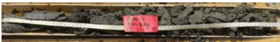
BG82_7.90 – 8.90m (セメント攪拌注入後)
