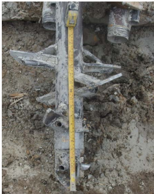
図 6.11 改良型攪拌棒形状
